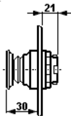
Schlagtastervorsatz "NOT - AUS"
