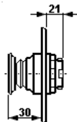
Face avant de bouton-coup de poing-ARRET D'URGENCE
