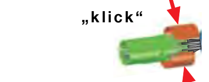
Fig. 15.5 geteilte Isolierhülse ansetzen
