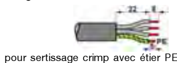
Dénudage des conducteurs en mm
