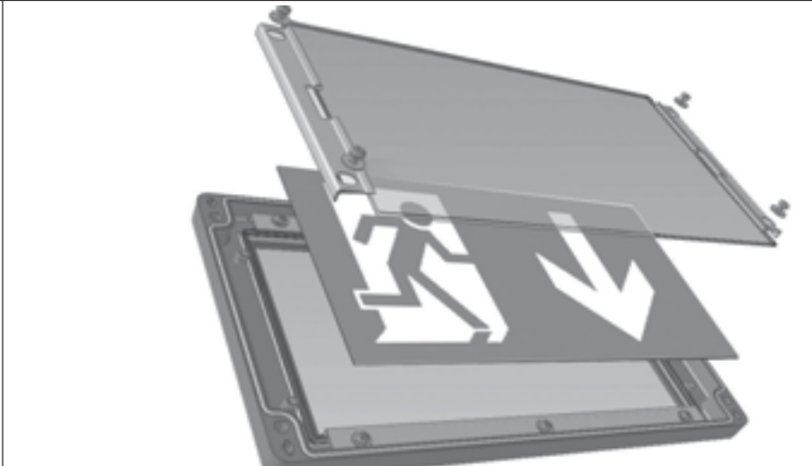
Bild 5/fig. 5/Fig. 5 Wechsel der Piktogramm-Scheibe/ Changing of legend-mask/ Replacement de pictogramme Modification du calibre de pictogramme
