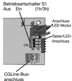
Netzkabel an den Klemmen N, L, L' und PE auf der Leiterkarte anschließen, wobei L als ungeschaltete Dauerversorgung der Elektronik und L' über einen Lichtschalter zur bedarfsabhängigen Schaltung der Leuchte dient.
