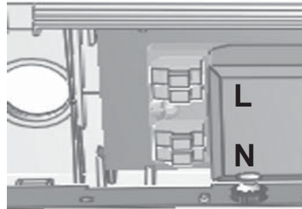
Bild 8.2 Fig. 8.2 Netzanschluß für 29021 LED Mains connection for 29021 LED
