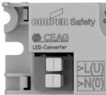
Leitungen einführen und das Netzkabel an den Klemmen L und N am Modul anschließen.
