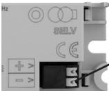
LED-Leiste an Klemme anschliessen (Bipolarer Anschluss der LED's - auf eine Polung muss nicht geachtet werden - ). Leuchtengehäuse von unten über die Leuchte schieben und an den Schnapphaken einrasten lassen.
